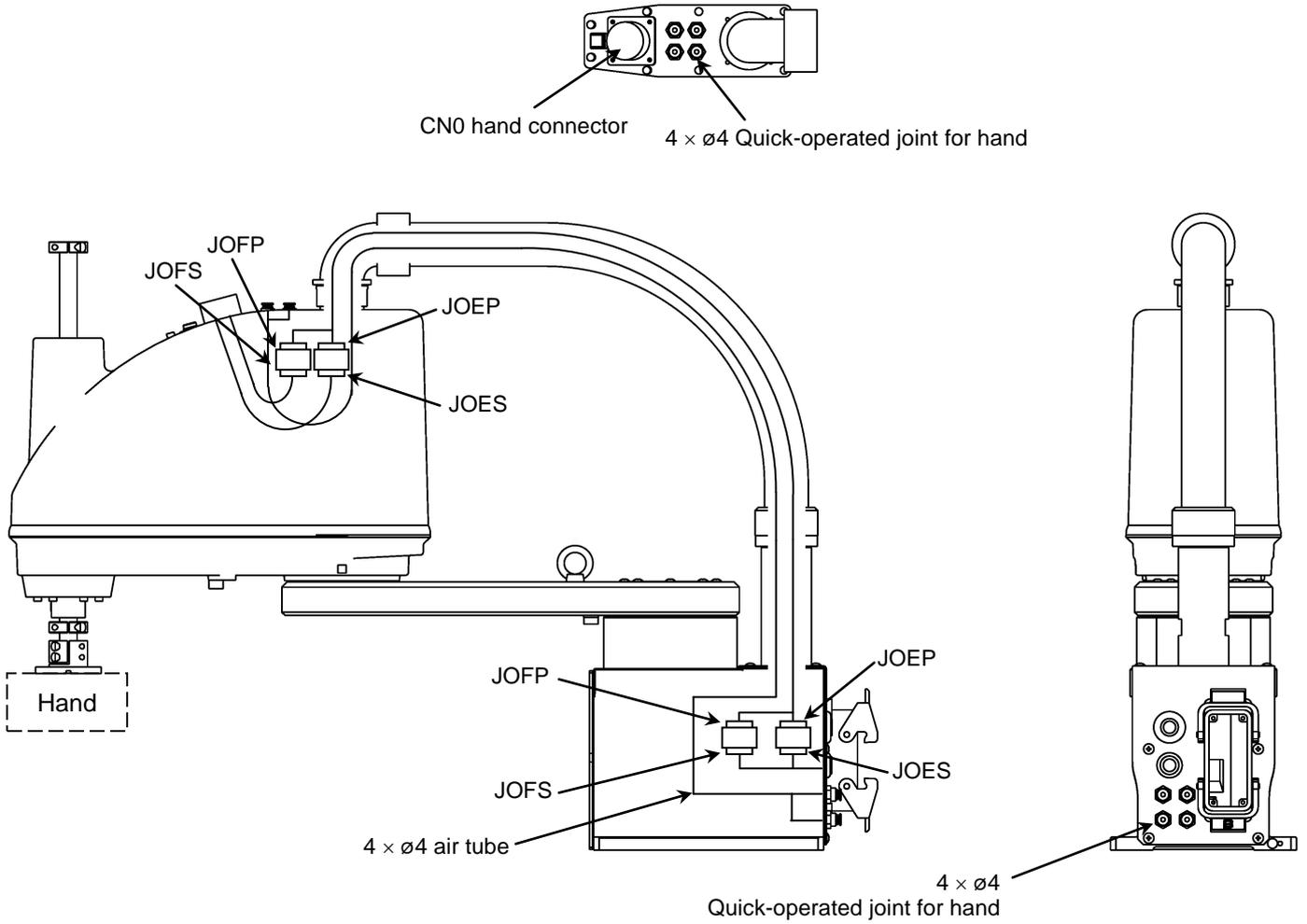
Fig. 5.3 Tool wiring ①
