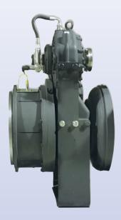
Die Montage des Elektromotors/Generators an das Parallel-Hybridgetriebe PHT geschieht über einen leistungsfähigen, für Drehmomente bis 1500 Nm ausgelegten PTO/PTI. Das interne Übersetzungsverhältnis von 1,47 oder 1,7 am PTI/PTO bietet zahlreiche Vorteile:
