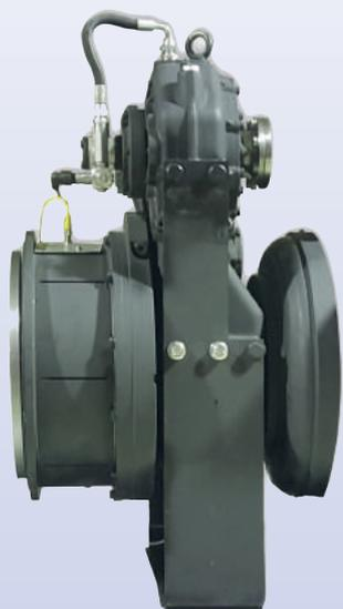
Die Montage des Elektromotors/Generators an das Parallel-Hybridgetriebe PHT geschieht über einen leistungsfähigen, für Drehmomente bis 1500 Nm ausgelegten PTO/PTI. Das interne Übersetzungsverhältnis von 1,47 oder 1,7 am PTI/PTO bietet zahlreiche Vorteile:
