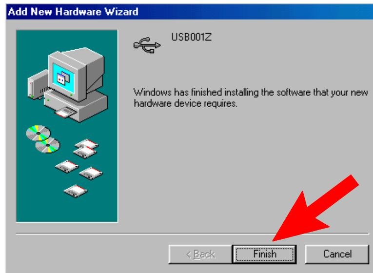
**(7) Der Treiber für den USB-Port wird nun installiert und die Installation aller notwendigen Treiber abgeschlossen.**
